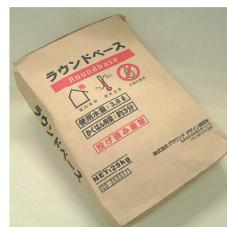
ラウンドベースは、溶融炉で鉄を製造する際に副産される高炉水砕スラグ(リサイクル材)を骨材として利用することで、硬化時の水和発熱反応を抑え、内部からのひび割れを抑制します。また、高炉スラグは天然の珪砂に比べて溶融シリカが少なく、アルカリ骨材は生じません。
